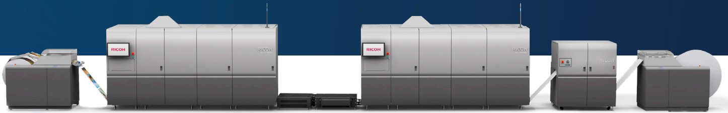
RICOH Pro VC70000e에 언와인더, 언더코터 및 리와인더 장착 이미지
